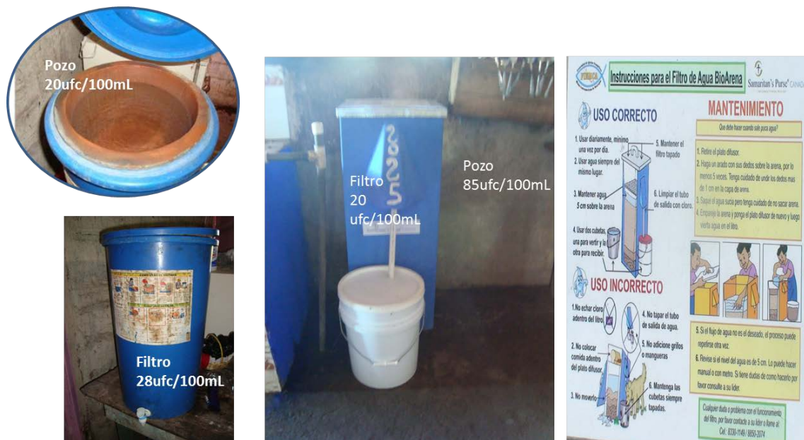
Figura 4. Tipo de filtros encontrados en las comunidades rurales del municipio de Larreynaga-Malpaisillo.
